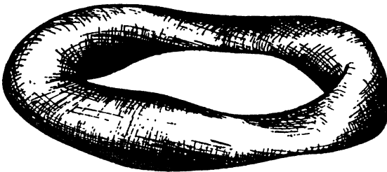
Рис. 4. Винтовая магнитная поверхность эллиптического сечения с круговой магнитной осью
